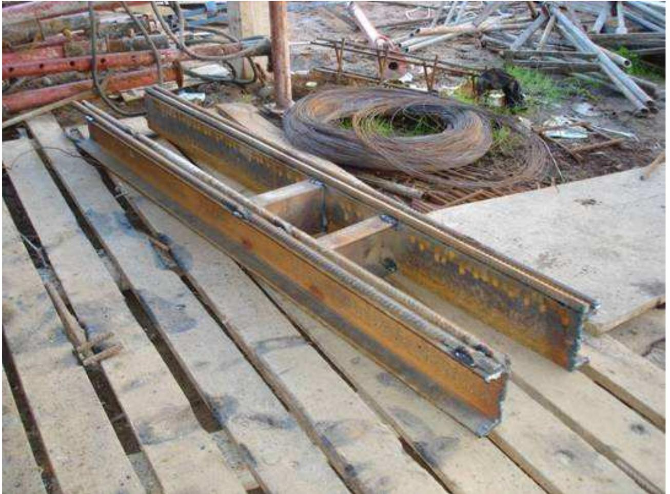
Рисунок 1.11. Закладная деталь распределительной системы (по Л.Л. Кукше)
