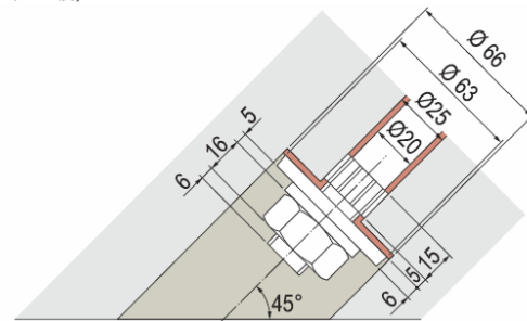
Головная часть анкера и расширение отверстия HZA-P M20
